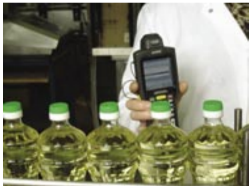
Nadzor pri prevzemu iz proizvodnje z ročnim terminalom
